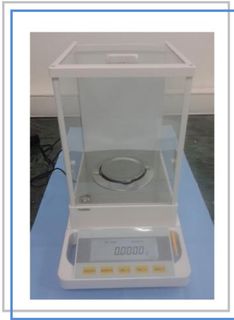
Imagen 3: Balanza analítica de 0,1 gramo de precisión.
