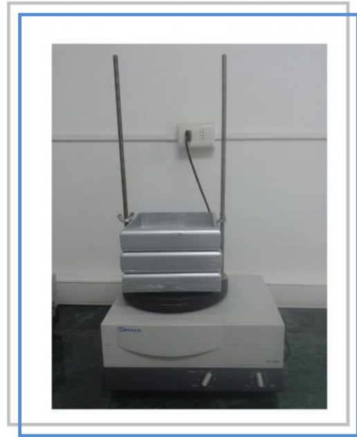
Imagen 4: Equipo de tamizado vibratorio.
