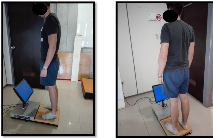
Figura 4. Medición del control postural estático a través de la plataforma posturográfica (ArtOficio).
