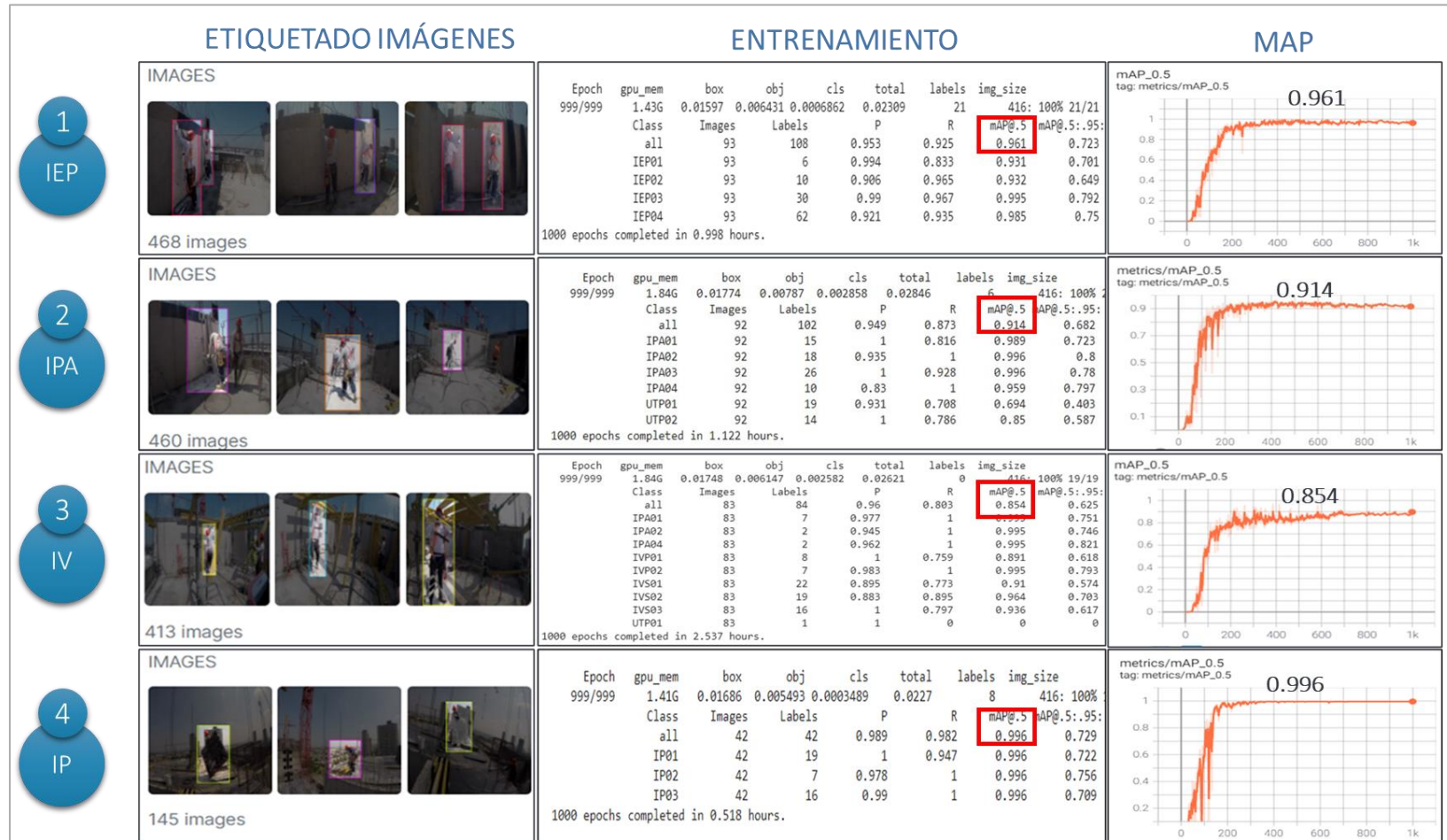
Figura C-1: Resumen proceso etiquetado y entrenamiento de YOLO
