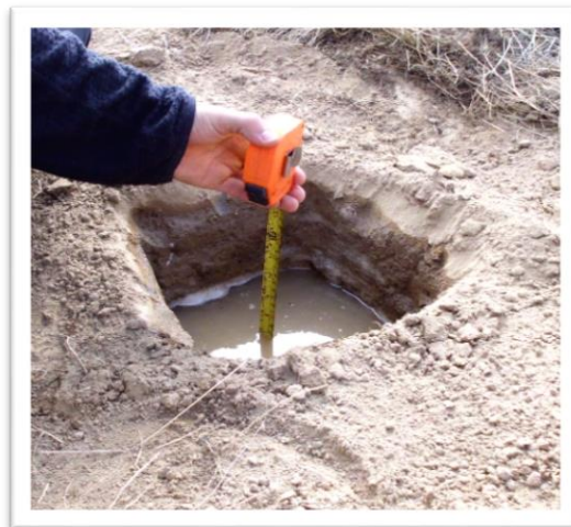
Figura 14: Cálculo de la permeabilidad en terreno mediante el método de Porchet. Calicata de 18 cm de diámetro x 25 cm de profundidad. Viña Miró.
