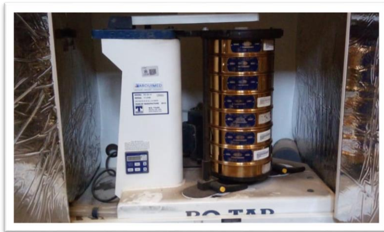
Figura 18: Agitador Arquimed (modelo: RX-29-10). En su interior, la columna de tamices utilizados para el análisis.
