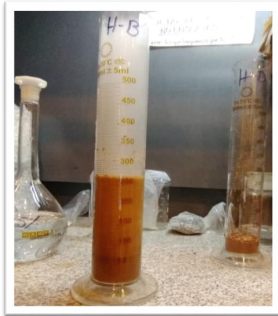
Figura 17: Ensayo de materia orgánica. En la probeta de 500 ml se observa la mezcla en reacción, entre la muestra y la solución de H 2 O 2 al 10%.
