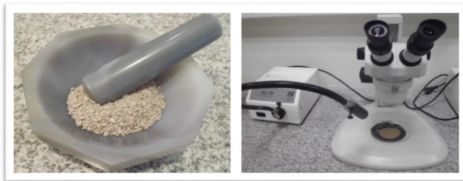
Figura 19: Instrumentos utilizados para el análisis granulométrico. A la izquierda: mortero utilizado para la disgregación manual de los sedimentos posterior al proceso de secado. A la derecha, lupa binocular estereoscópica con aumento de 10x a 40x.
