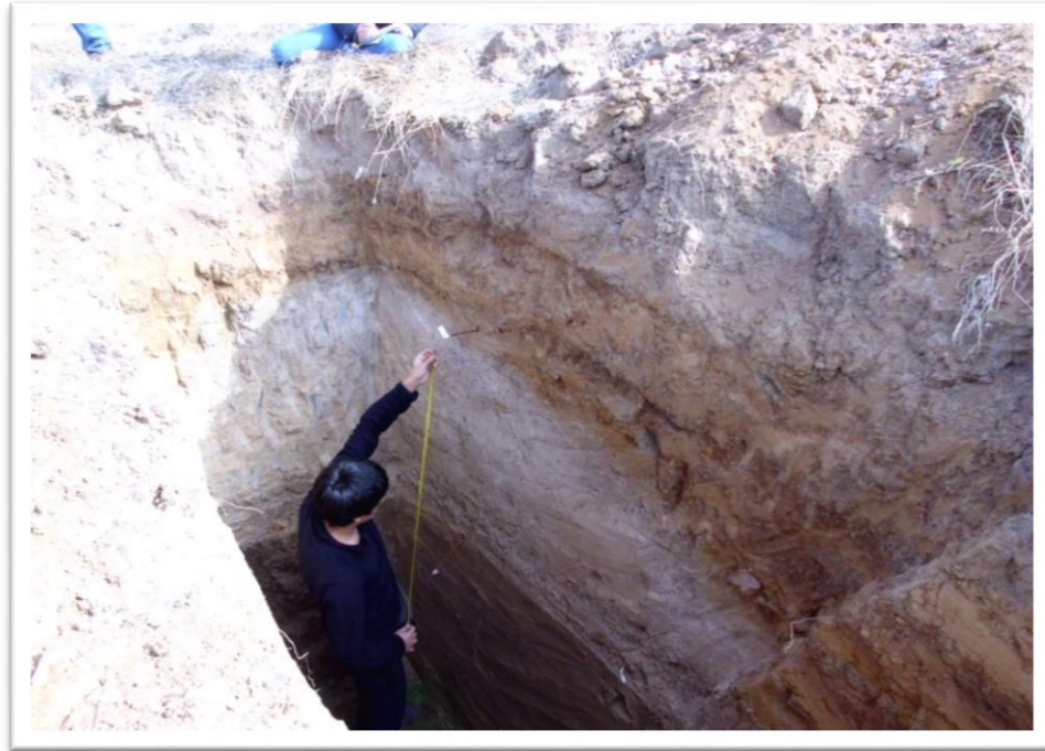
Figura 13: Descripción litológica y estratigráfica de los horizontes de suelo. Calicata de 1 m de ancho x 3 m de largo x 2.5 m de profundidad.
